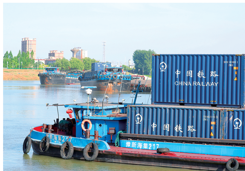
6月7日,沈丘刘湾港内,满载集装箱的千吨级货轮整装待发。依托沙颍河道优势,当地打通铁水联运通道,铁路集装箱从码头直接装上内河船舶,实现水陆无缝中转,大幅压降货运成本,持续助力周口临港产业与内河航运高质量发展。 记者 刘俊涛 摄
